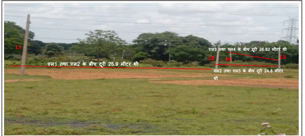
फरवरी 2020 में राँची (मक्का-7 और मुरुपिरी-11) और गिरिडीह (जादु रैडीह-5 और बरिया-4) जिलों के चार गांवों में 27 पोल के भौतिक सत्यापन से पता चला कि दो एलटी पोल के बीच की दूरी 20 से 37 मीटर के बीच थी जबकि 40 मीटर का मानदंड था।
